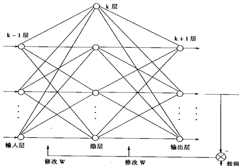
它包括输入层、输出层以及处于输入输出层之间的中间层。中间层可以为单层或多层，由于它们和外界没有直接联系，故也称为隐含层，隐含层中的神经元称隐单元。隐含层虽然和外界不连接，但它们的状况会影响输入输出之间的关系。也就是说，改变隐含层的权系数，可以改变整个多层神经网络的性能。
