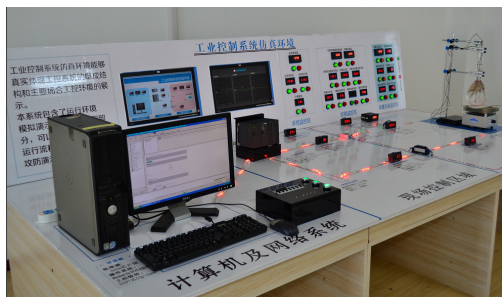
图1 安天在分析Stuxnet过程中临时搭建的工控沙盒
